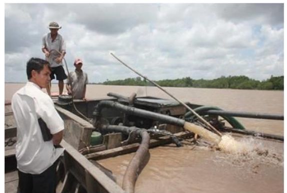
Hình 7. Khai thác cát bằng công nghệ hút thổi lên ghe
