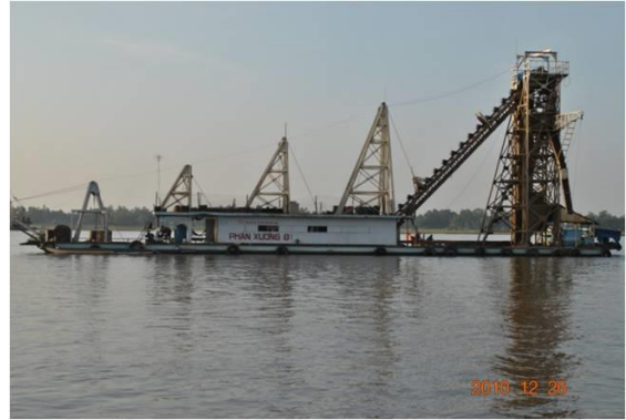
Hình 9. Khai thác cát bằng công nghệ xáng guồng trên sông Tiền, xã Phú Thuận B, Hồng Ngự, tỉnh Đồng Tháp
