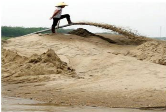
Hình 6. Khai thác cát bằng công nghệ hút thổi lên bờ
