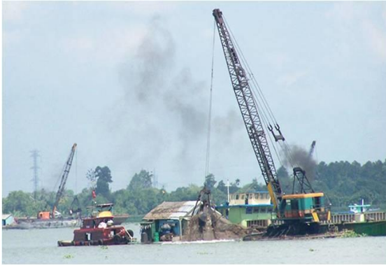
Hình 8. Khai thác cát bằng công nghệ xáng cạp (Lê Mạnh Hùng, 2013)
